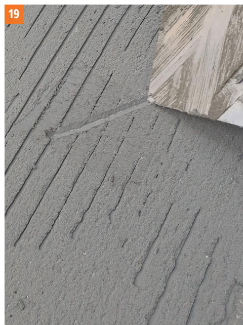
Foto. 20, 21 Geoflex Express. Odtrhnutie obkladového prvku nalepeného na vrstve lepidla s hrúbkou 3 mm po 3 hod. – účinok zničenia podkladu.
