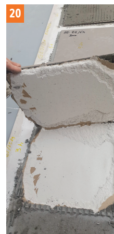
Foto. 20, 21 Geoflex Express. Odtrhnutie obkladového prvku nalepeného na vrstve lepidla s hrúbkou 3 mm po 3 hod. – účinok zničenia podkladu.
