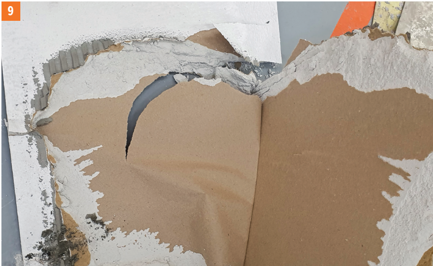
Foto. 8, 9 Geoflex Express. Skúška odtrhnutia obkladového prvku po 1,5 hod., ale s maximálnym množstvom zámesovej vody (7,5 l/25 kg): skúška odtrhnutia – zničenie podkladu.
