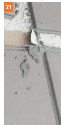
Foto. 20, 21 Geoflex Express. Odtrhnutie obkladového prvku nalepeného na vrstve lepidla s hrúbkou 3 mm po 3 hod. – účinok zničenia podkladu.
