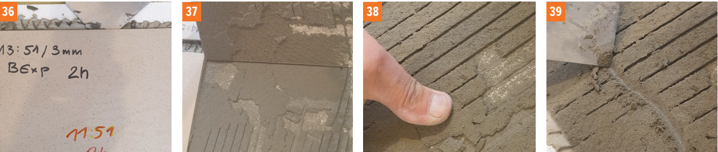
Foto. 36, 37, 38, 39 Rýchlo tuhnúce lepidlo č. 2 (trieda „F“). Po zdvihnutí dlaždice je zreteľne viditeľné odtrhnutie vo vrstve lepidla. Lepidlo je zavädnuté iba čiastočne, ľahko sa rozotiera prstom alebo nástrojom.
