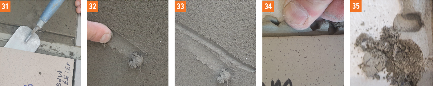
Foto. 31, 32, 33 Rýchlo tuhnúce lepidlo č. 1 (trieda „F“) vo vrstve s hrúbkou 15 mm – proces tuhnutia je porovnateľný s tradičnými lepidlami. Foto. 34, 35 Skúška tvrdosti rýchlo tuhnúceho lepidla č. 2 (trieda „F“). Po 2 hod. tuhnutia vo vrstve s hrúbkou 3 mm vykazuje nízku tvrdosť (lepidlo je možné ľahko rozdrviť „na zube“ po stierke) a má stále vysokú vlhkosť v svojej štruktúre – drobí sa, farba na prelomení je však tmavošedá (foto. 35).
