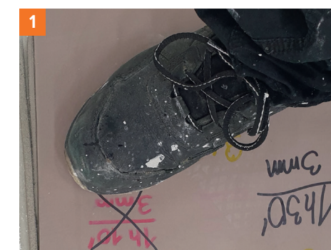
Foto. 1,2,3 Lepidlo ATLAS Geoflex Express – lepenie v letných podmienkach, okolitá teplota 28,5°C, hrúbka vrstvy 3 mm, skúšky po 1,5 hod. Zľava: 1. Skúška zaťaženia (s rotáciou) – bez prepádania dlaždíc alebo ich odlepenia, 2. Skúška odtrhnutia (odtrhnutie pomocou tzv. zábradlia), 3. Skúška tvrdosti – hladítko prejde niekoľko mm pod obkladový prvok.
