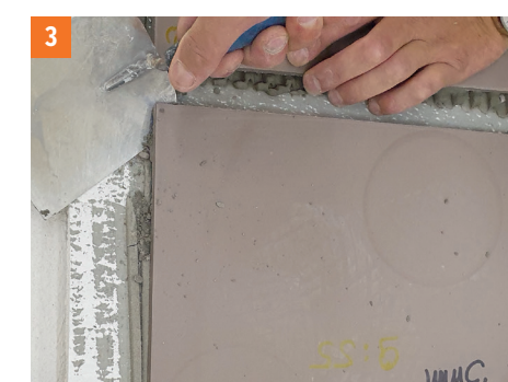
Foto. 1,2,3 Lepidlo ATLAS Geoflex Express – lepenie v letných podmienkach, okolitá teplota 28,5°C, hrúbka vrstvy 3 mm, skúšky po 1,5 hod. Zľava: 1. Skúška zaťaženia (s rotáciou) – bez prepádania dlaždíc alebo ich odlepenia, 2. Skúška odtrhnutia (odtrhnutie pomocou tzv. zábradlia), 3. Skúška tvrdosti – hladítko prejde niekoľko mm pod obkladový prvok.
