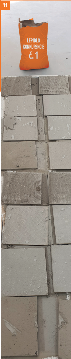
Foto. 10, 11, 12 Výsledky skúšok odtrhnutia vybraných lepidiel podľa schémy na obr. 1. Okrem spôsobu odtrhnutia treba venovať pozornosť aj stupňu zafarbenia lepidla pod dlaždicou, čo dokazuje mieru straty vlhkosti v lepidlách, zvýšenie pevnosti a možnosť začatia škárovania dlažby.
